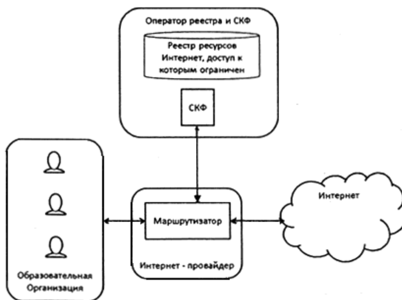
Рис.5. Схема работы контент-фильтрации при едином решении
