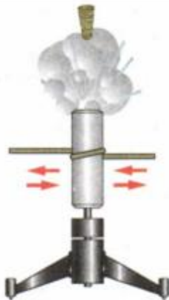
Рис. 3. Увеличение внутренней энергии тела при совершении работы над ним
